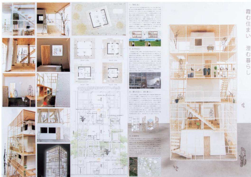
「映える」という今回の投げかけに、作者は「霞む住まい 澄む暮らし」という美しく詩的な言葉でこたえてくれた。提案は、5層をなす塔状建築。中央に居室をもつRC造のコアがあり、その四周を半外部空間とし、階段やバルコニーがコアに巻き付くように配置されている。建物全体は、不規則なリズムで大小に割り付けられたフレームと、視覚的に透過性のある材料で覆われている。コアをなすRC壁は内側に傾斜し、半外部空間は上階にいく程大きくなる。一方、2階全体を半屋外空間として開放することによって、3階以上のRC造のコアは、空中に浮遊しているかのように見える。
