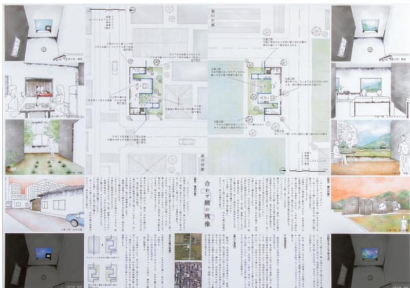
最近注目されている2拠点生活の提案です。東京と北海道、それぞれを楽しむ住宅の平面は、ひとつの長方形を凸凹線によって2分割したもので、合わせ鏡のように互いを補完し合う構成となっています。
